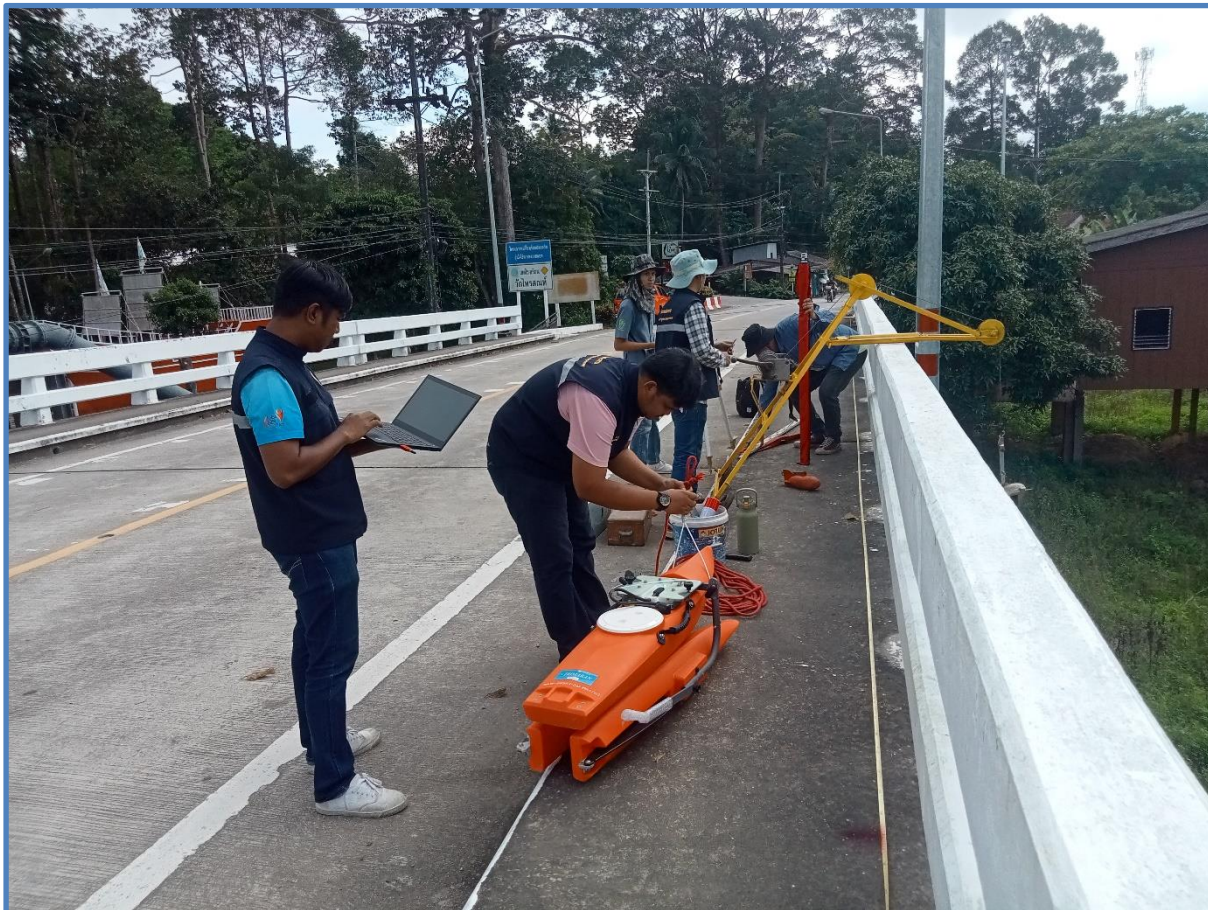
รูปที่ 10 ทำการคำนวณปริมาณน้ำที่สำรวจได้ ที่สถานี X.234 แม่น้ำตรัง บ้านป่าหมาก อ.เมือง จ.ตรัง
