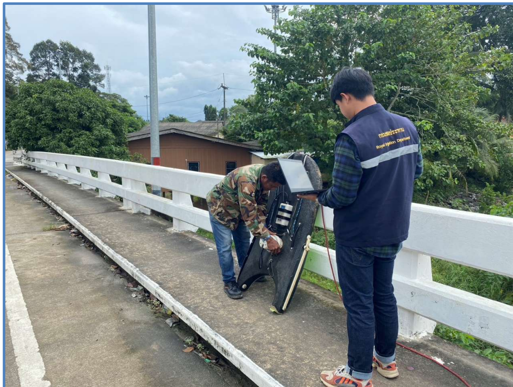
รูปที่13 ทำการคำนวณปริมาณน้ำที่สำรวจได้ ที่สถานี X.234 แม่น้ำตรัง บ้านป่าหมาก อ.เมือง จ. ตรัง
