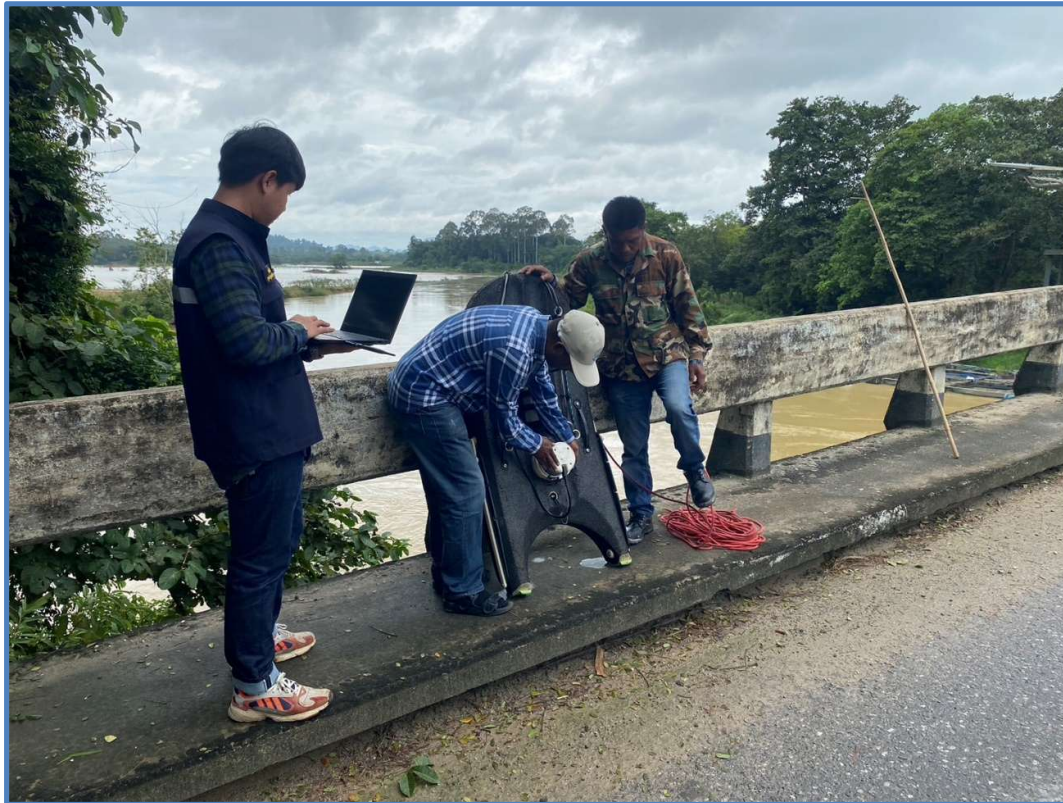
รูปที่ 9 ทำการคำนวณปริมาณน้ำที่สำรวจได้ ที่สถานี X.228 แม่น้ำตรัง บ้านกลาง อ.เมือง จ.ตรัง
